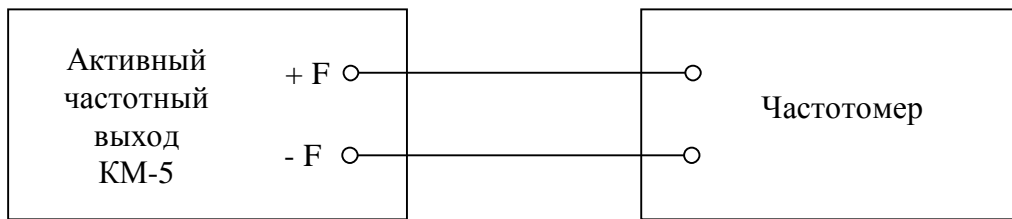
Рис. П1б. Электрическая схема подключения измерительных приборов при поверке частотного выхода КМ-5.
